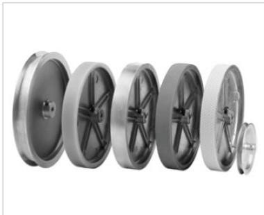
Messräder dienen zur Umsetzung linearer Bewegung in rotative Bewegung, Z.B. um Längen von Profilen, Kabeln Fäden oder Bandmaterialien mittels Zählern oder Drehgebern zu erfassen.
