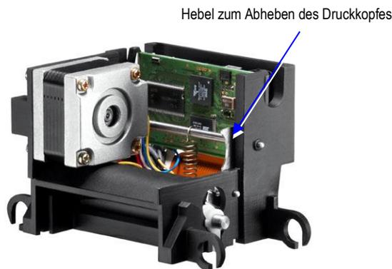
Befindet sich die Papierbahn zwischen Druckkopf und Druckwalze, so ist vor dem manuellen Zurückziehen der Papierbahn die Friktion zwischen Kopf und Walze durch Niederdrücken des Hebels aufzuheben.
