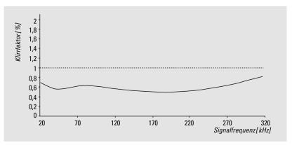
Entscheidend für die Qualität des Regelkreises ist die Oberwellenfreiheit der Geber-Sinussignale, insbesondere bei niederen Drehzahlen. Um hohe Interpolationsfaktoren in der Folgesteuerung zu ermöglichen stehen die inkrementalen Sinussignale A und B mit einem Klirrfaktor von deutlich unter 1 % über den gesamten spezifizierten Temperaturbereich zur Verfügung. Dies bringt exzellente Gleichlaufeigenschaften und hohe Positioniergenauigkeit bei Servoachsen.
