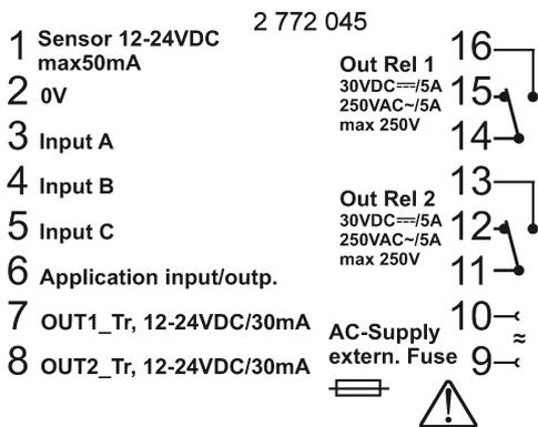
VAC Trafo 2 Relais / 2 Transistoren
