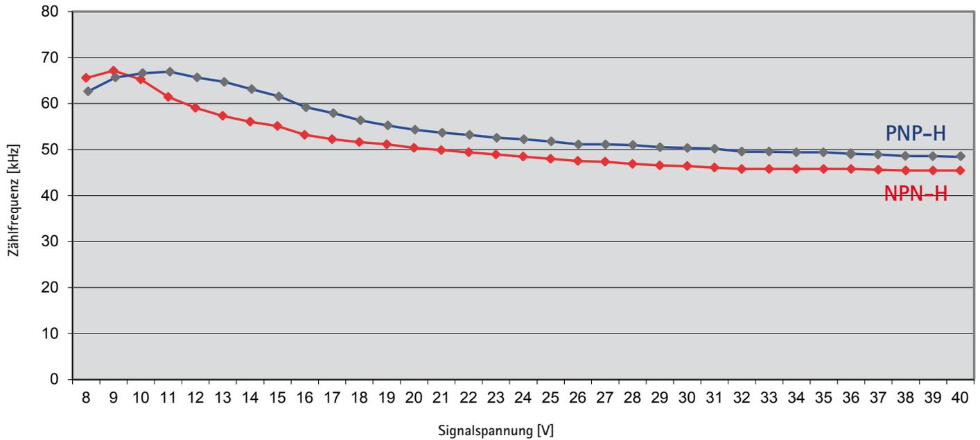
Die Zählfrequenzen wurden bei einem Signalgenerator mit einem Ausgangswiderstand von 50-Ohm ermittelt.
